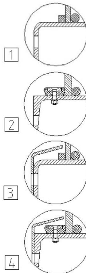
дуктов. Обеспечивает 100-процентную герметичность.
